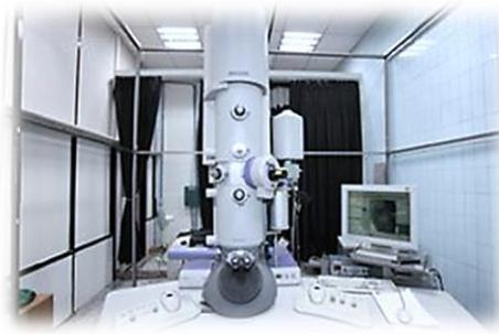
圖3-3場發射槍穿透式電子顯微鏡
