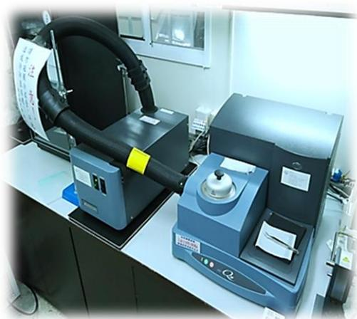
圖 3-15 熱示差量熱儀
