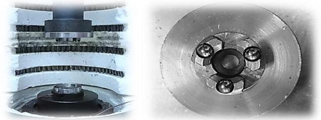
圖 3-18 實體配置與 pin-on-disk 配件圖
