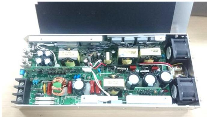
圖 5 被動式直流-直流轉換器實體結構
