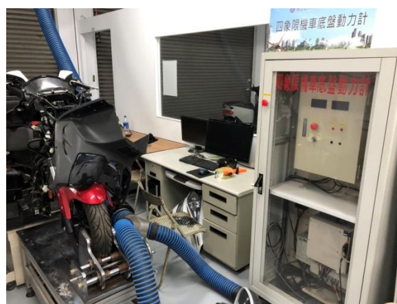
圖3.8 機車固定在底盤動力計
