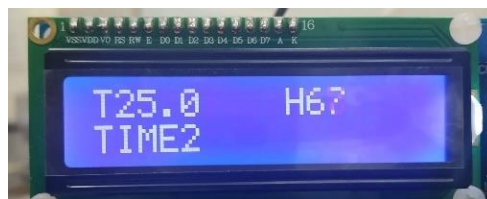
圖20 LCD螢幕(TIME為24小時制的計時器)
