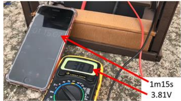
圖11 太陽能板在太陽下充電前電壓3.81V
