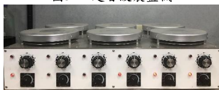
圖3.13 磁石加熱攪拌機
