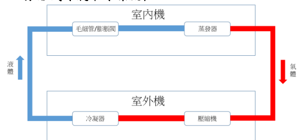
圖2 分離式冷氣冷媒循環
