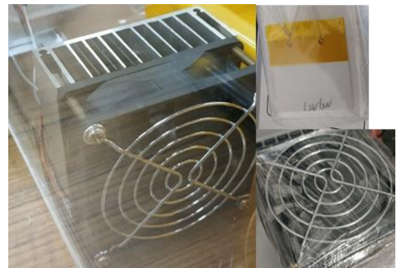
圖12 加熱器(左)由加熱晶片(右上)及散熱器組成(右下)
