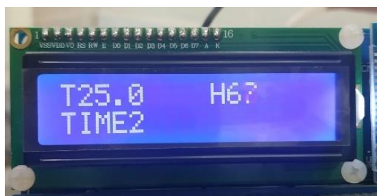
圖17 LCD螢幕(T指溫室箱內溫度)
