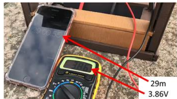
圖12 太陽能板在太陽下充電30分鐘後電壓3.86V
