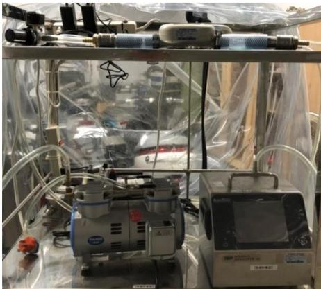
圖 19 粉塵微粒測定器
