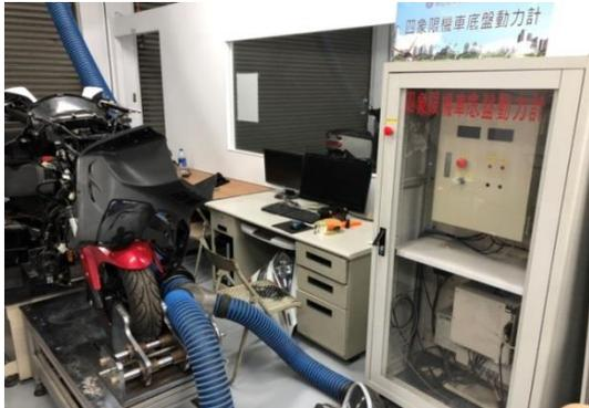
圖 17 四象限底盤動力計
