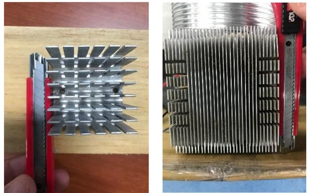
圖11 散熱片更換
