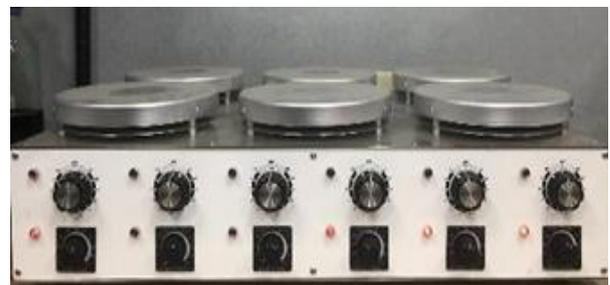
圖4 電磁加熱攪拌器
