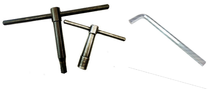
板手組 (夾頭板手、刀座板手、8mm六角板手)
